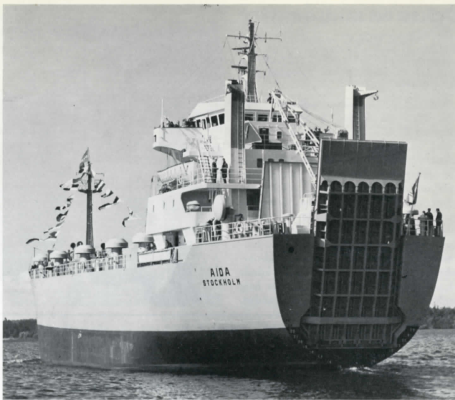
M/S "AIDA" var vid leveransen den 30/8 1966 på 3.660 tdw och 80 m mellan perpendiklarna samt gjorde 13,3 knop. Hon förlängs i dagarna vid Ekensberg med ca 12 m vilket beräknas öka tonnage med omkring 800 ton.
